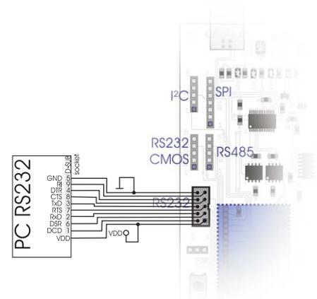
*Hinweis: Unter der Bestellbezeichnung EA KV24-9B kann ein Schnittstellenkabel bestellt werden, welches den direkten Anschluss an einen PC ermöglicht. Die Länge beträgt 1,5m*
