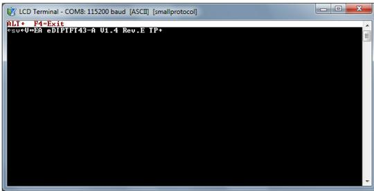
erscheint eine Auswahl der verfügbaren Schnittstellen. Wählen Sie hier die Einstellung mit dem Text x: eDIP Programmer (COMx). Die auf dem Evaluationboard eingestellte Baudrate ist 115.200. Danach aktivieren Sie das Small-
