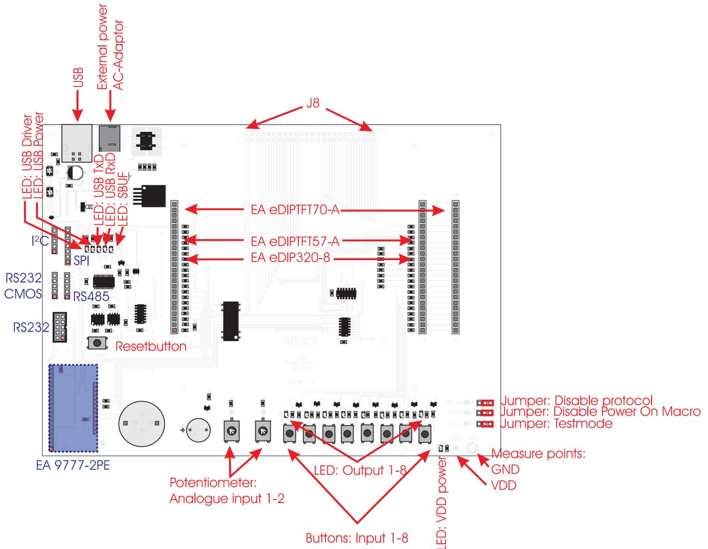
Das Evaluationboard bietet viele Features, angefangen von LED's zur Anzeige des Datentransfers bis hin zu Potentiometern um die Analogeingänge der eDIPTFTs nutzen zu können.
