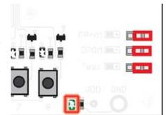
das EVAL-Board mit Spannung verorgt ist, leuchtet die Spannungs-LED unten rechts.
