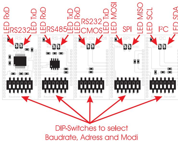
Die als Option erhältliche Zusatzplatine EA 9777-2PE erweitert das Evaluationboard um wichtige Schnittstellen: „echte“ RS232 (mit +/-12V-Pegeln), RS232 CMOS, RS485, SPI und I<sup>2</sup>C.
